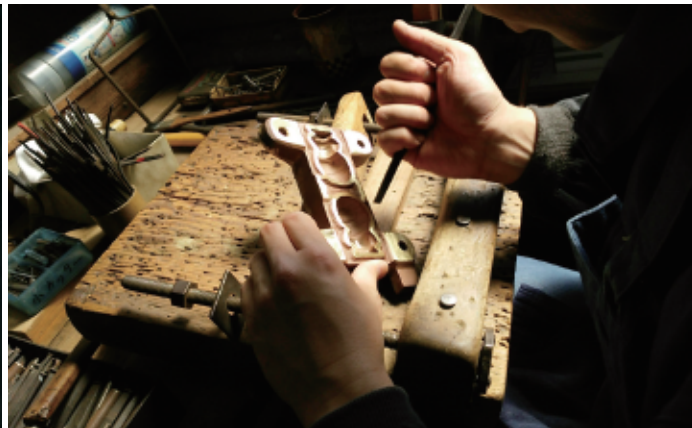
吹き込み成形用のセルロイド金型を作る 平成28(2016)年 モールドメーカー(株)カミジヨー協力
